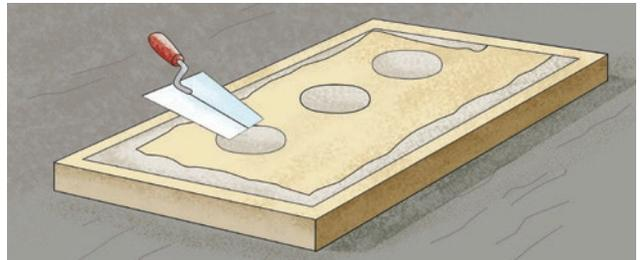
2. Для достижения хорошей адгезии клея РОКглю с поверхностью плит требуется нанесение предварительного слоя. Оно осуществляется путем втирания клея в поверхность утеплителя с помощью кельмы на те участки, где следующим этапом будет наноситься основной слой состава РОКглю.
