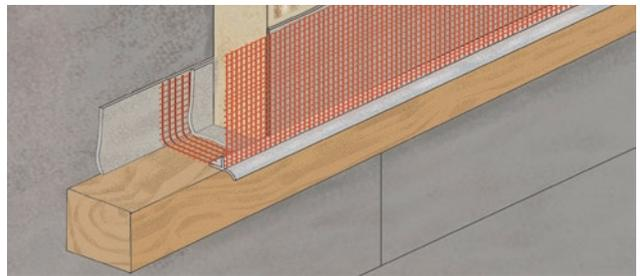
6. Монтаж системы возможно осуществить без применения цокольного профиля – с помощью деревянного бруска, стеклотканевой сетки РОКфайбер-Б и профиля-капельника.
