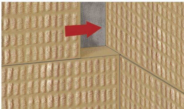
14. Монтаж плит на внутренних углах осуществляется с перевязкой вертикальных стыков.
