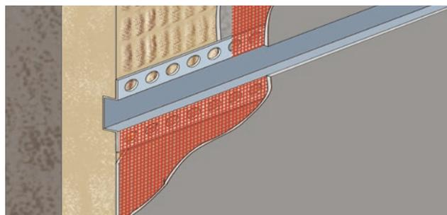
8. Для отделки декоративных форм – рустов – используется рустовочный профиль. Для его монтажа на поверхности теплоизоляционной плиты прорезаются с помощью фрез продольные углубления (штрабы) на глубину выбранного рустовочного профиля. Далее в это отверстие втапливается рустовочный профиль. При выполнении стыковки двух профилей место стыка обрабатывается герметиком или под профили устанавливается продольный соединительный П-образный элемент с самоклеющимися вставками.
