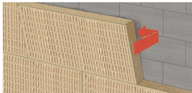
6. Сразу же после нанесения клея плиту прикладывают к стене, плотно придвигая к уже приклеенным, и прижимают ударами длинной терки.
