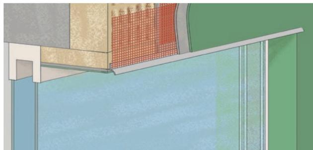
6. Горизонтальные внешние углы, расположенные над оконными и дверными проемами, рекомендуется усиливать с помощью угловых профилей с капельником для предотвращения попадания воды на горизонтальные плоскости.
