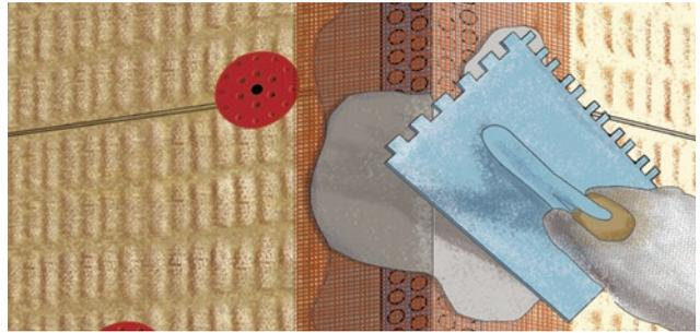
1. Для достижения трещиностойкости системы в районе вершин углов оконных и дверных проемов производится предварительное армирование под углом 45° «косынками» из стеклотканевой сетки РОКфайбер-Б размером 40x20 см. Для этого после предварительного втирания смеси РОКмортар на участок поверхности смонтированных плит (площадью, которая чуть больше площади «косынки») наносится основной слой РОКмортар толщиной около 2 мм, где утапливается сетка РОКфайбер-Б легким движением гладкой стороны шпателя.
