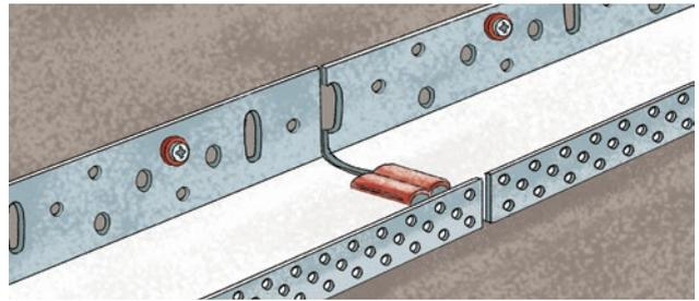
4. Цокольные профили должны быть соединены друг с другом соединительным элементом во избежание появления трещин в отделочном слое ввиду термического расширения профиля. Зазор между соседними цокольными профилями должен быть 2-3 мм.
