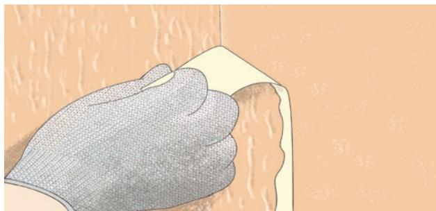
7. Работы на одной поверхности следует выполнять непрерывно, придерживаясь правила нанесения «мокрое по мокрому». Работы могут быть приостановлены только при установке клейкой малярной ленты на границе отделки перед нанесением крайней полосы штукатурного слоя. После нанесения крайней полосы такого слоя до его высыхания необходимо удалить малярную ленту.
