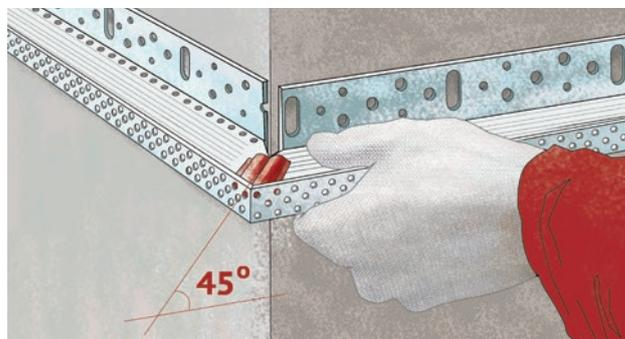
2. На углах здания профиль вырезается под углом 45°.
