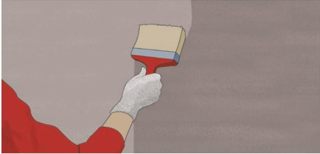
1. Окончательная отделка фасада возможна по истечении не менее трех суток после нанесения базового штукатурного слоя. Для достижения хорошей адгезии поверхность армирующего слоя грунтуется составом РОКпраймер при помощи кисти или валика.
