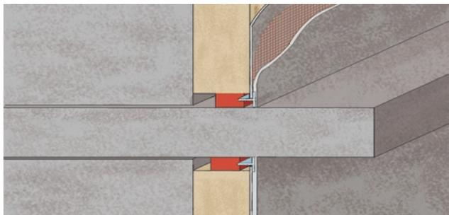
7. В случае примыкания торца утеплителя к существующим неутепляемым конструкциям, таким как соседние здания, балконные плиты, ригели, кронштейны крепления осветительных приборов, камер видеонаблюдения, их стык с плитой осуществляется через уплотнительную саморасширяющуюся ленту. Лента приклеивается одной стороной к примыкающей конструкции таким образом, чтобы она располагалась близко к наружной поверхности утеплителя, но не выходила за нее.
