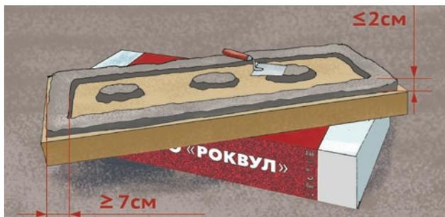
3. Клей РОКГлю наносят на обработанную поверхность утеплителя с помощью кельмы, создавая «бортик» шириной не менее 7 см с отступом от края плиты не менее 2-3 см и 3-8 крупных точек (диаметр – не менее 5 см) в середине плиты. Высота слоя нанесенного клея должна составлять не более 2 см. После установки теплоизоляционной плиты в проектное положение площадь адгезионного контакта между плитой и основанием должна составлять не менее 40 % от ее площади.
