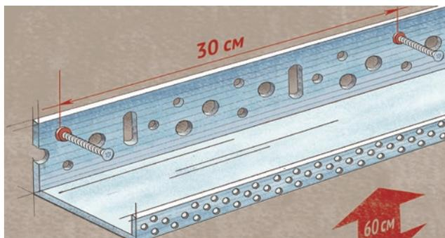
1. Цокольный профиль монтируется на высоте 60 см над уровнем земли (или в соответствии с проектом). Закрепление профиля осуществляется с использованием дюбеля для крепления цокольного профиля. Расстояние между крепежом – не более 30 см.
